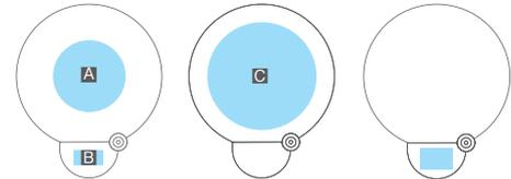
Aシルク: 直径100mm C転写: 直径150mm インクジェット: W45×H30mm
